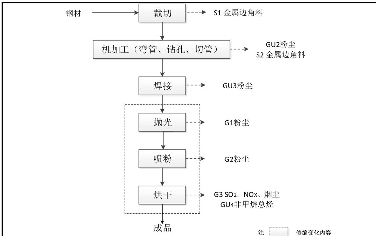
通用机械零部件、钣金件生产工艺流程图
