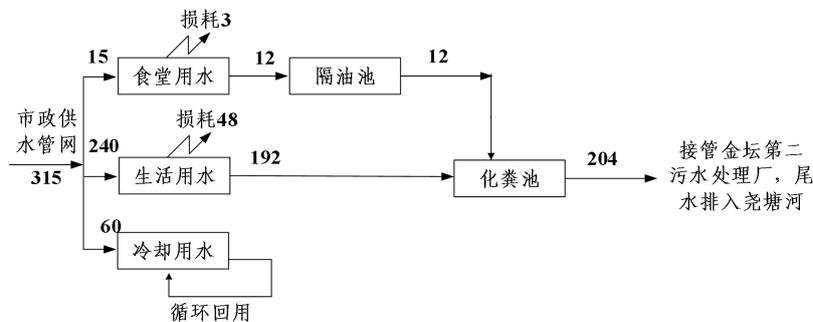
图 5-1 本项目水平衡图(m<sup>3</sup>/a)
