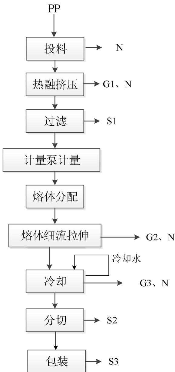
图 5-1 生产工艺流程及产污环节图
