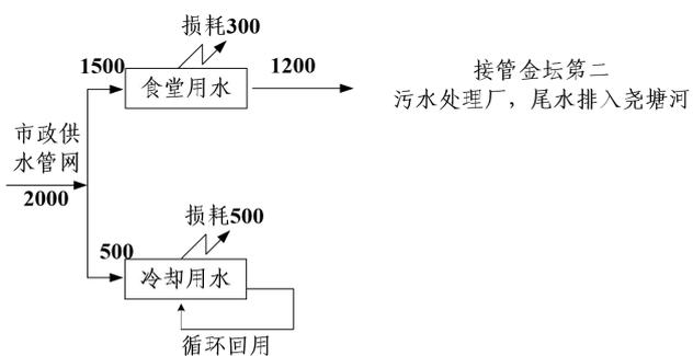
图 1-1 现有项目水平衡图 (m<sup>3</sup>/a)
