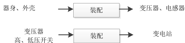
图 5-5 变电站、变压器、电感器加工工艺流程图
